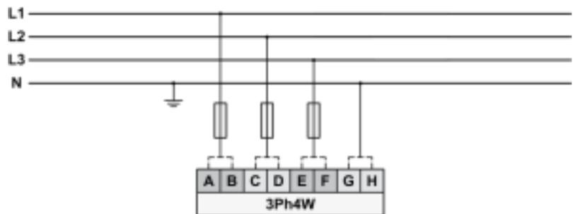
Fig. 33: Measuring inputs - 3Ph 4W
