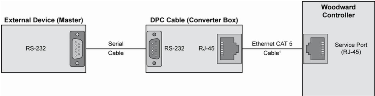
Fig. 56: DPC-RS-232 wiring - schematic
